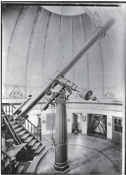
Fig. 27. – Le Grand Réfracteur dans les années vingt (Esclangon 1926). On remarque très bien sur la droite une structure à escaliers se déplaçant sur le pourtour de la coupole et qui existe encore de nos jours. La partie centrale peut aussi s'élever et s'abaisser pour positionner au mieux l'observateur en fonction de l'orientation de la lunette. (© Obs. Astron. Strasbourg)
